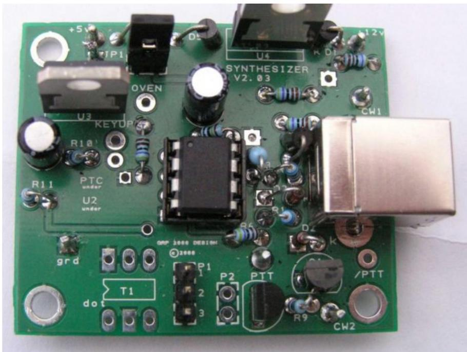
ПРИ ПОМОЩИ ДАННОГО СИНТЕЗАТОРА ИМЕЮЩЕГО МАЛЫЕ ШУМЫ И ХОРОШУЮ СПЕКТРАЛЬНУЮ ЧИСТОТУ С ПРОГРАММАМИ [POWERSDR-SR40 v13](#), [PowerSDR 1.12.20](#) И [ROCKY 3.6](#), ВЫ МОЖЕТЕ УПРАВЛЯТЬ по USB ЧАСТОТОЙ, ПЕРЕКЛЮЧАТЬ ДИАПАЗОНЫ НА МИНИТРАНСИВЕРАХ TXRX, 6.1-6.2, AVALA01 и т.д. ВО ВСЕМ ДИАПАЗОНЕ КВ (как с SDR1000).
